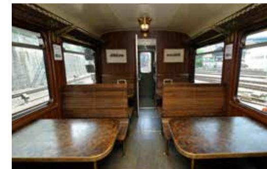
Das Pendler-Pintli wurde zusammen mit dem Hoschtet-Schnägg im Jahr 1916 zur Eröffnung der Elektrischen Solothurn-Bern-Bahn (ESB) geliefert. Im Jahr 1956 erfolgte der Abbruch des Wagenkastens. Drei Jahre später wurde ein komplett neuer Wagenkasten in Stahlbauart gebaut. So ist das Pendler-Pintli genau genommen kein Nostalgiezug, jedoch bei Gesellschaften sehr beliebt.
