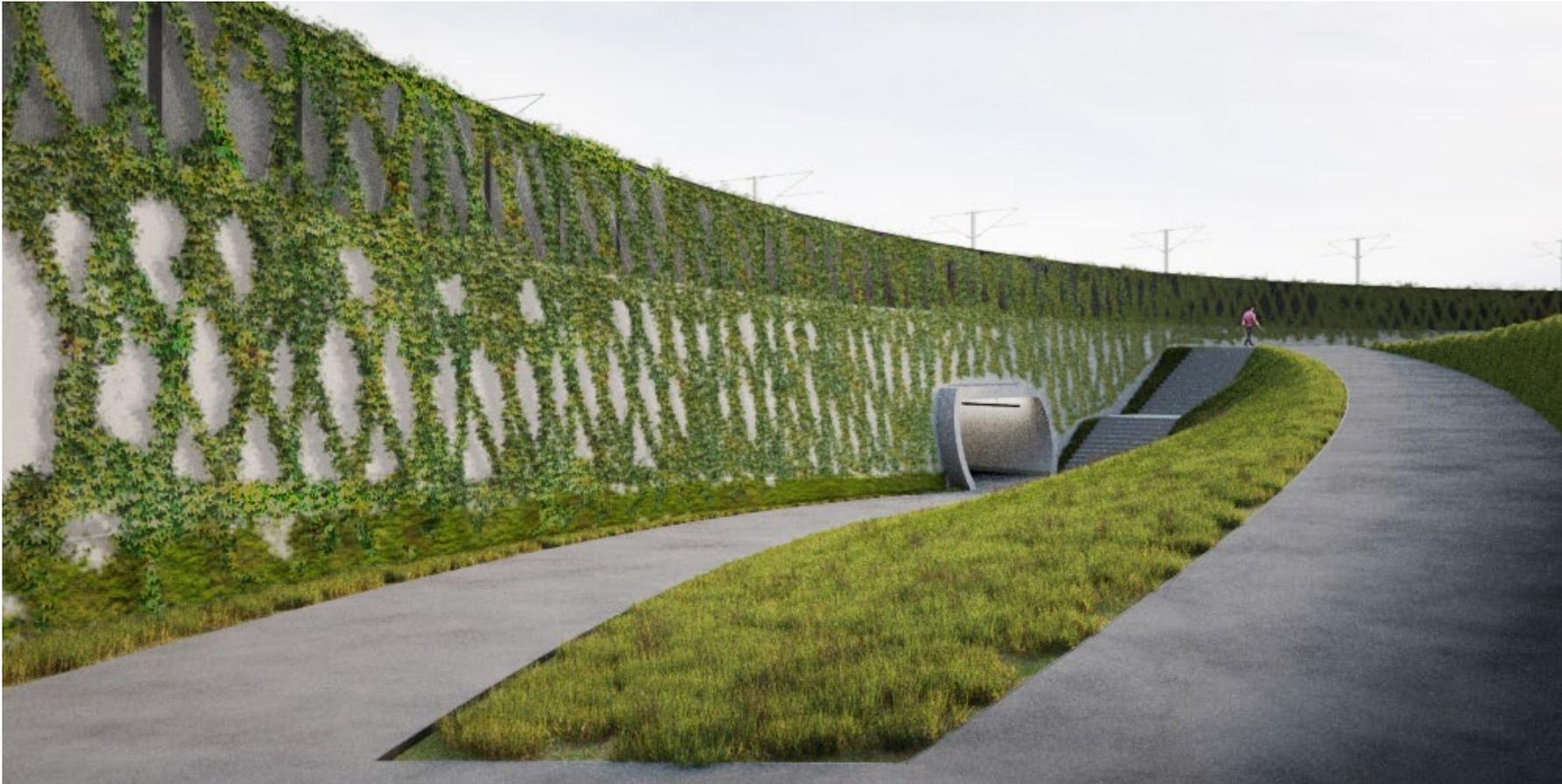
Unter der Depotzufahrt für die Züge entsteht eine neue Unterführung für den Langsamverkehr, die auf beiden Seiten von einer Lärmschutzwand abgeschlossen wird. Die 3,3 Meter hohe Lärmschutzwand wird mit Ranken bepflanzt und so gebaut, dass der Strassenlärm nicht reflektiert wird. Die Züge sind hinter der Lärmschutzwand nicht zu sehen.
