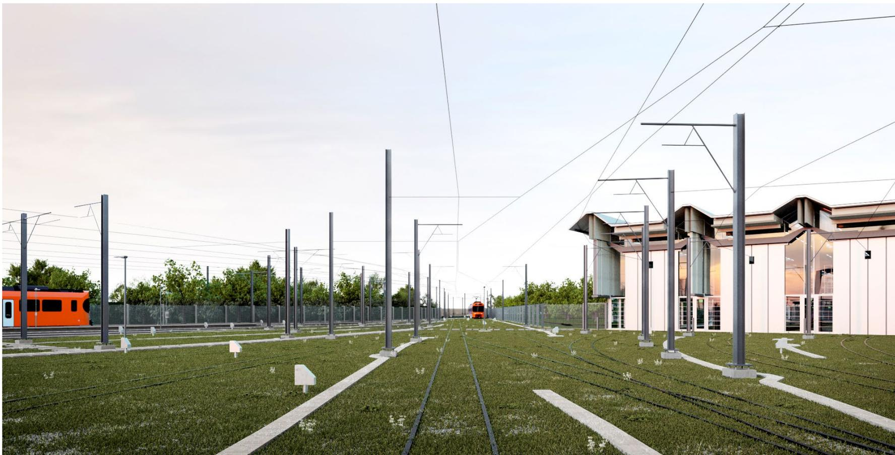
Als erste Bahn der Schweiz plant der RBS im Depotvorfeld eine Grüngleisanlage. Die Abstellanlage bietet Platz für vorerst 18 Züge. Die Gleise für die Baufahrzeuge werden im hinteren Teil der Anlage erstellt. Die Depotanlage wird Richtung Kyburgstrasse mit einem Lärmschutzwand mit Bäumen resp. in der Zufahrtskurve mit einer begrünten Lärmschutzwand abgeschlossen.
