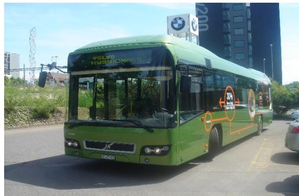
Bild 4: der serielle MAN-Hybrid im Einsatz auf der Linie 38 in Mattstetten. Bild 5: der Volvo 7700 ist ein Parallellhybrid.
