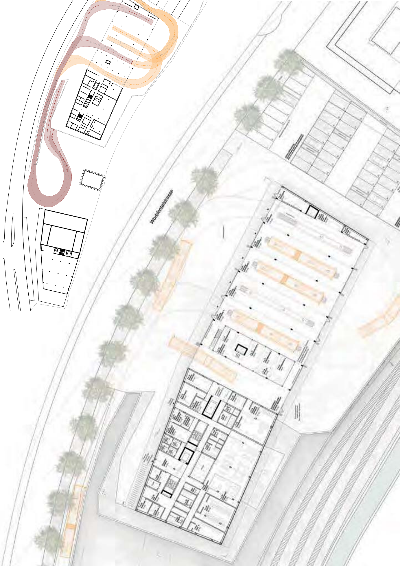
links: Ergebnis der Schleppkurvensimulation an den massgebenden Stellen für Ebene 1 (Werkstatt Bushof), M. 1:500
