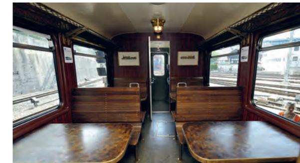
Das Pendler-Pintli nahm zusammen mit dem Hoschtet-Schnägg im Jahr 1916 zur Eröffnung der Elektrischen Solothurn-Bern-Bahn (ESB) den Betrieb auf. Im Jahr 1956 erfolgte der Abbruch des Wagenkastens. Drei Jahre später wurde ein komplett neuer Wagenkasten in Stahlbauart gebaut. So ist das Pendler-Pintli genau genommen kein Nostalgiezug, jedoch bei Gesellschaften sehr beliebt.
